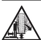
Le operazioni di sollevamento della ruota vanno eseguite con estrema cautela. Per evitare il rischio di ribaltamento della ruota, si raccomanda di trattenerla con una mano durante gli spostamenti del carrello.
