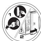
Vor Servicearbeiten an der Maschine den Netzstecker aus der Steckdose ziehen.
