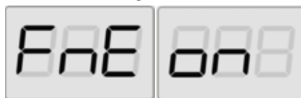
Fig. 28 : Activation de l'affichage des balourds en haute résolution
