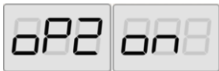
Fig. 30: Activación memoria operador 2 - La memoria del operador 1 es almacenada
