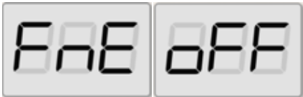
Abb. 29: Sperren der Unwuchtanzeige mit hoher Auflösung
