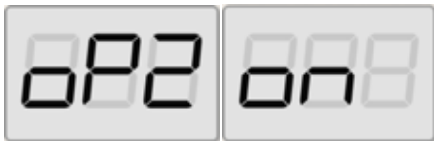
Abb. 30: Freigabe des Speichers Bediener 2 - Der Speicherinhalt von Bediener 1 wird gespeichert
