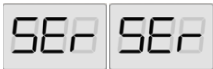
Fig. 32: Modo SERVICE activado
