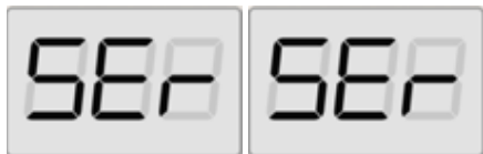
Abb. 32: Modus SERVICE freigeschaltet
