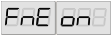
Fig. 28: Activación visualización del desequilibrio en alta resolución
