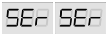
Fig. 32: SERVICE mode enabled
