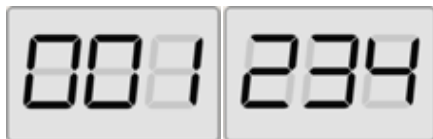
Abb. 33: Anzeige der Anzahl der Auswuchtdurchläufe
