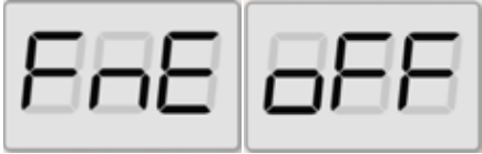
Abb. 29: Sperren der Unwuchtanzeige mit hoher Auflösung
