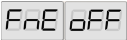
Fig. 29: Desactivación visualización del desequilibrio en alta resolución
