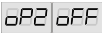
Fig. 31: Desactivación de la memoria del operador 2 - La memoria del operador 1 será recuperada
