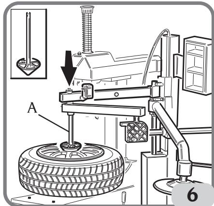
Das Rad mit zuvor abgedrücktem Reifen auf das Spannfutter positionieren und von der Außenseite einspannen; den Felgenniederhalterkegel am Ende der Gelenkkarre (Abb. 6) anbringen, den Kegel an das Mittelloch der Felge führen, den Absenkhebel betätigen, bis sich die Spannklaue zwischen Felge und Reifen einfügen (Abb. 6.1), und schließlich das Pedal drücken, um das Rad zu sperren. Den Zentrierkegel entfernen und wieder in seinem Sitz ablegen Abb. 4.3.
