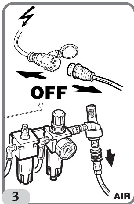
1. Interrrompre l'alimentation électrique et pneumatique de l'appareil Fig. 3.
