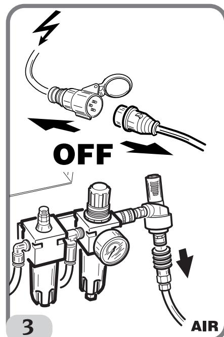
1. Die Maschine von Strom- und Druckluftversorgung trennen (Abb. 3);
