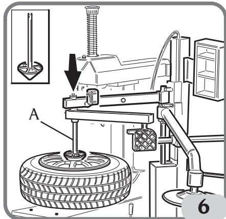
Portare la ruota precedentemente stallonata sull'autocentrante e bloccarla dalla parte esterna; applicare il cono premicerchio nell'apposita sede nello snodo dei bracci fig. 6, portare il cono in corrispondenza del foro centrale del cerchio, azionare la leva di discesa fino ad ottenere l'inserimento dei cunei di bloccaggio tra cerchio e copertura (fig.6.1), quindi premere il pedale per bloccare la ruota.
