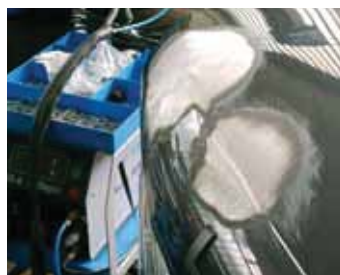
Heller ikke helt så spektakulære skader på aluminiumsplader er mindst lige så rentabelt for istandsætter. Besparelsen i forhold til en udskiftning er på denne Land Rovers motorhjelmsskade mere end 45 procent.
