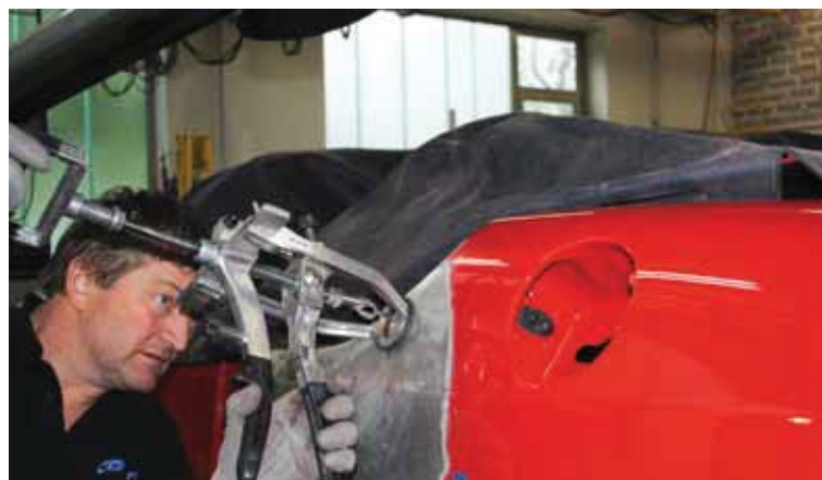
Sidevægsskaden på denne Ferrari Scuderia 16M er simpelthen uoprettelig med konventionelle reparationssystemer til aluminium. AluRepair systemet fra Carbon GmbH sætter her nye standarder - selvom reparationer af aluminium altid kræver træning og håndværkskunst.
