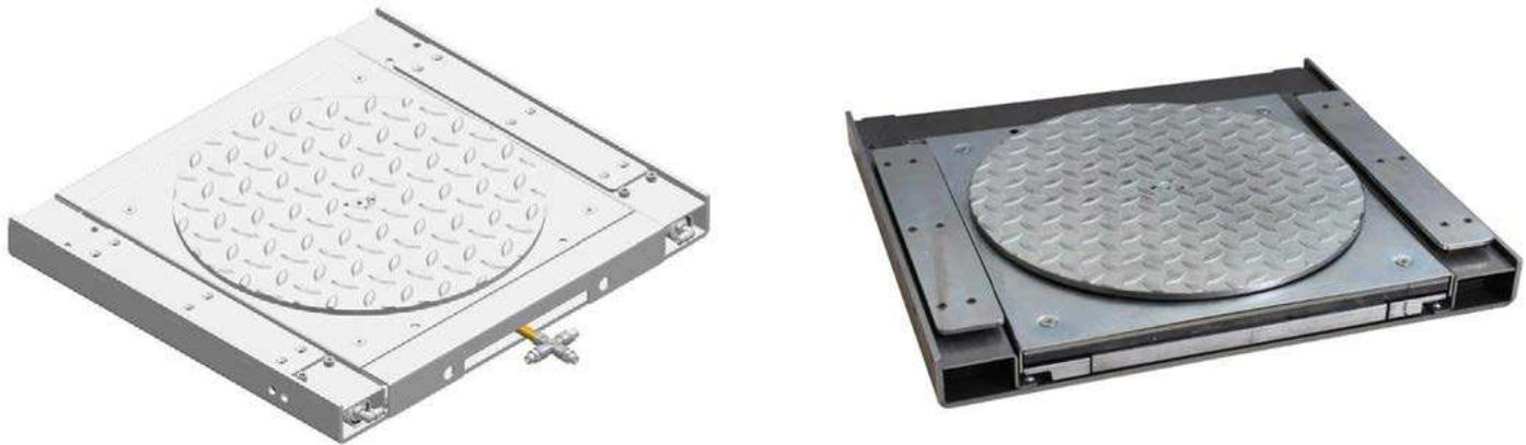
Coppia di piatti a bloccaggio pneumatico installabili su ogni tipo di ponte, che consente di eseguire il ROC in spinta. Attraverso un dispositivo a controllo pneumatico, è possibile bloccare il piatto nelle fasi di posizionamento della vettura, sbloccarlo per consentire le oscillazioni necessarie alle operazioni di calibrazione, e bloccarlo nuovamente per eseguire il ROC in spinta.
