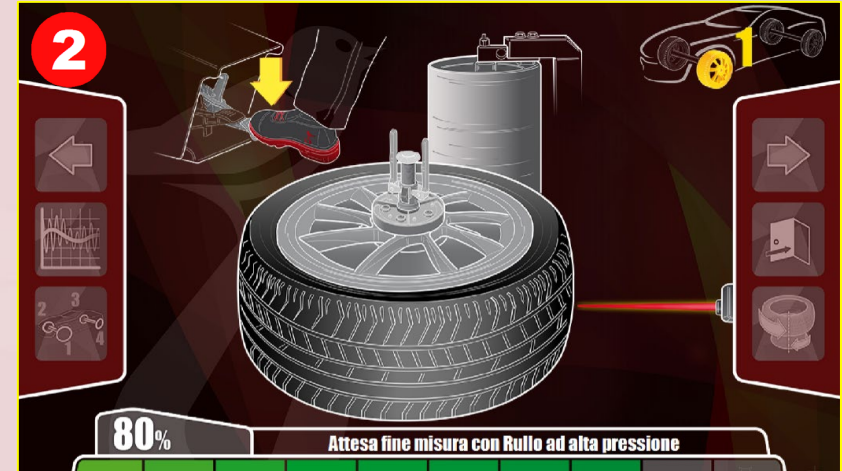
Kombineret laser og trykrulle måling
