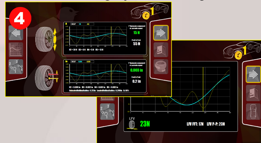
Evt. fejl og deformiteter kan udpeges ved hjælp af diagramvisningen
