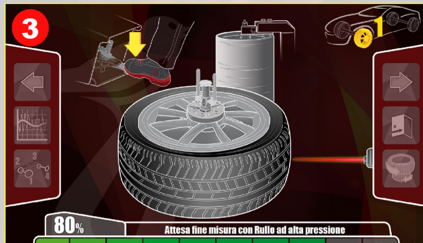
Kombineret laser og trykrulle måling ved rotation med- og mod uret
