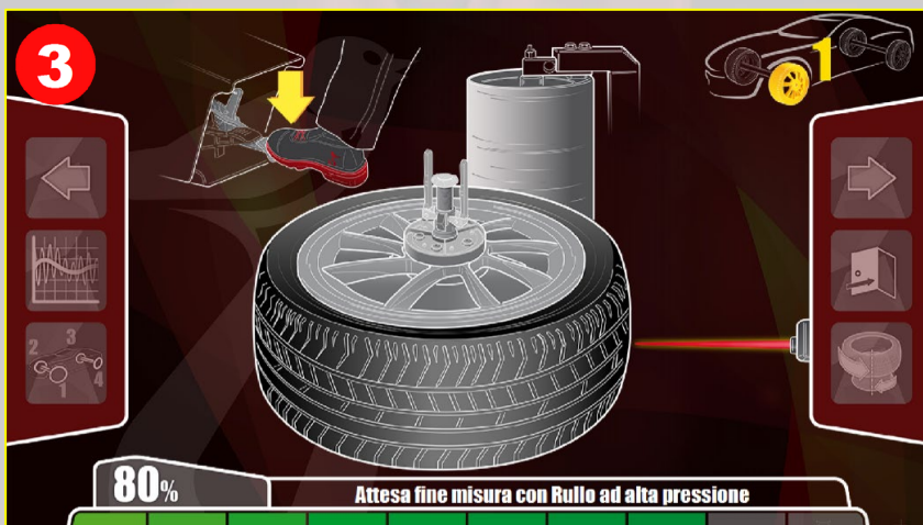
Dæk-på-fælg diagnose (med laser og trykrulle)
